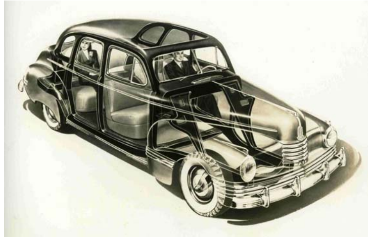
Figura 49. Tall del Nash 600 (1942); en anglès, a aquest tipus de dibuixos se'ls coneix com X-Ray drawing .
